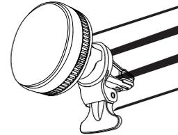
3. エアコンフィンにクラブ部を差込み、レバーを回転させてクラブを固定してください。
